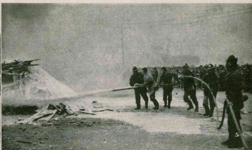
La misma ardiendo, pero con un lado ya apagado con una lanza n.º V de un rendimiento de 5.000 litros de Espuma de Aire por minuto.
