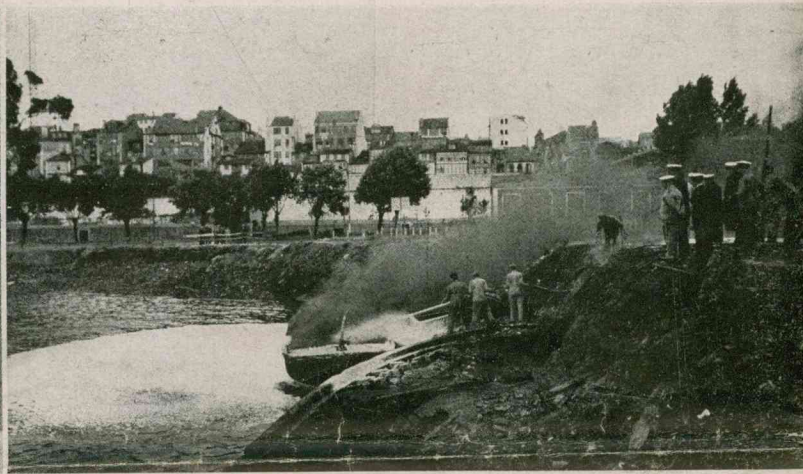
Pruebas realizadas en el Arsenal de El Ferrol del Caudillo, ante las autoridades de dicha base, el día 24 de mayo de 1943, sobre una gabarra llena de gasolina y que se apagó en un minuto a pesar del fuerte viento contrario.
