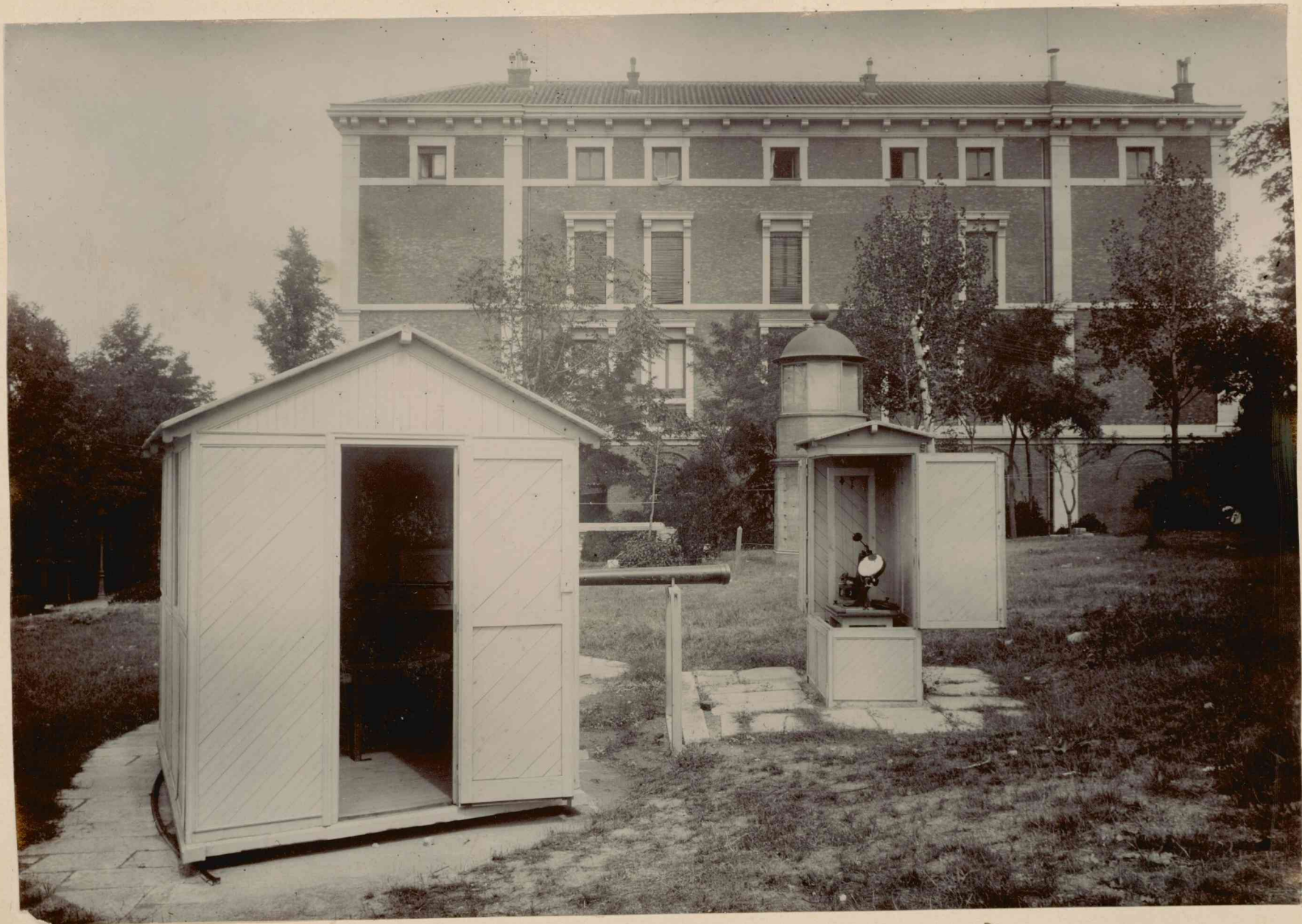
Celostato de Grubb y espectroscopio de sus prismas de Pellin
